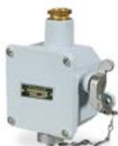
Πριζοδιακόπτες με μανδάλωση τύπου UNAV 1436 από βαμμένο ορείχαλκο σε χρώμα γκρι μαρέν με στυπιοθλίπτες UNAV 1948 50-60Hz IP56
