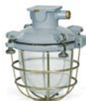
Φανός τύπου UNAV 2139 από βαμμένο ορείχαλκο σε γκρι μαρέν χρώμα, με πλέγμα προστασίας και στυπιοθλίπτες UNAV 1948 από ανοξείδωτο χάλυβα 230V IP66
