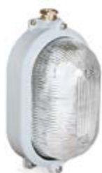
Πλαφονιέρες τύπου UNAV 2135 από βαμμένο ορείχαλκο σε γκρι μαρέν χρώμα, με γυάλινο κάλυμμα και στυπιοθλίπτες UNAV 1948 230V IP66
