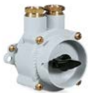
Περιστροφικοί διακόπτες τύπου UNAV 2162 από βαμμένο ορείχαλκο σε γκρι μαρέν χρώμα με στυπιοθλίπτες UNAV 1948 250V IP66
